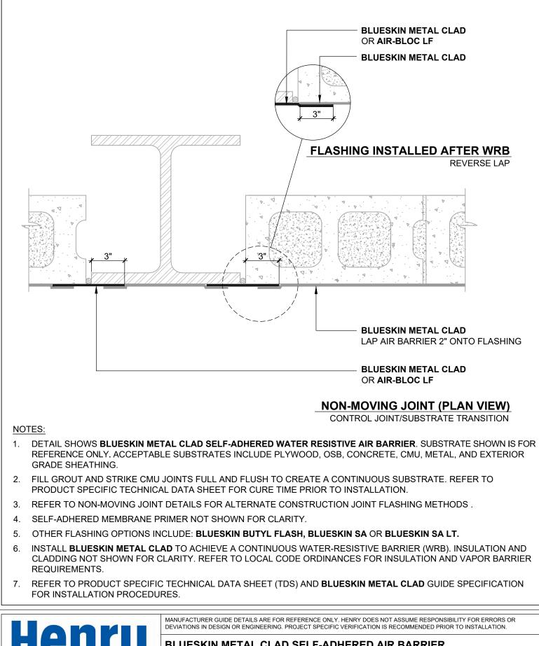
**BLUESKIN METAL CLAD SELF-ADHERED AIR BARRIER**
